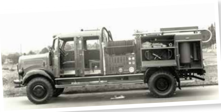
Imposantes Unikat: Einsatzleitwagen (ELW) der Flughafenfeuerwehr Stuttgart auf Mercedes-Chassis. Pikante Besonderheit: Der ELW verfügte über eine Halon-2402-Löschanlage.
