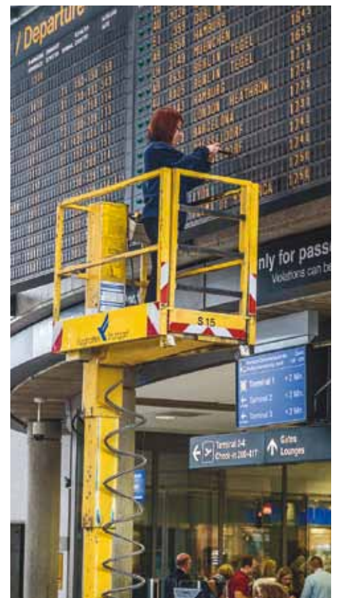
Ist ein Fallblatt-Modul defekt, tauscht Elena Bergler es schnell aus – schließlich soll auf der Tafel nichts Falsches stehen.
