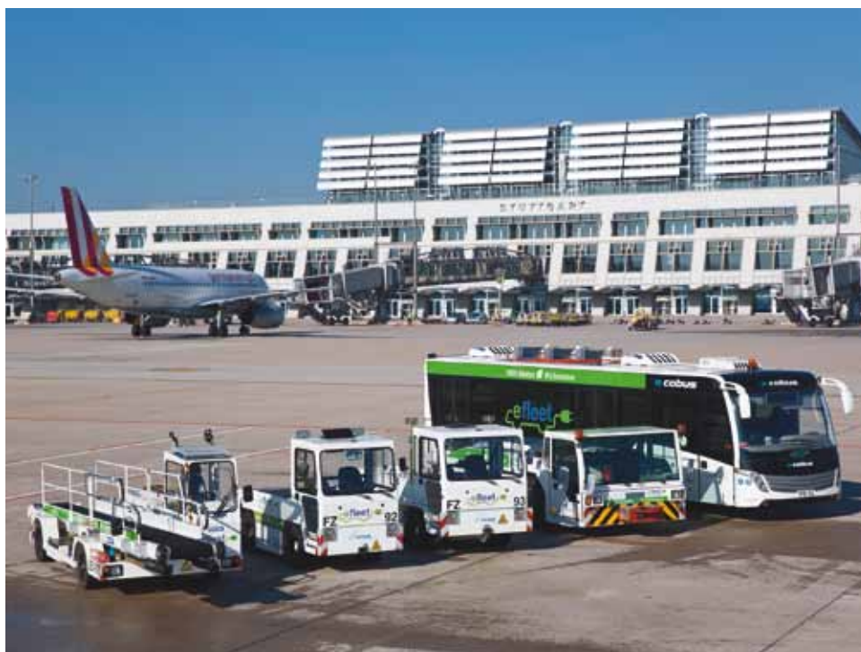
Bus, Schlepper und Pushback-Fahrzeug brauchen kein Benzin und kurven leise übers Vorfeld.
