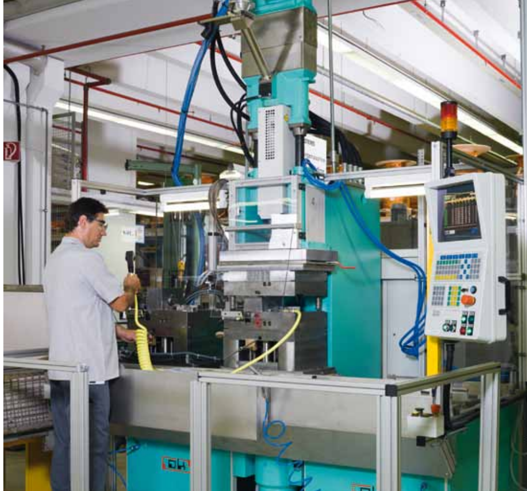
Wenn elektrischer Strom transportiert wird, müssen Verbindungen gut isoliert sein. An speziellen Maschinen erhalten Ladestecker einen Mantel aus Kunststoff.
