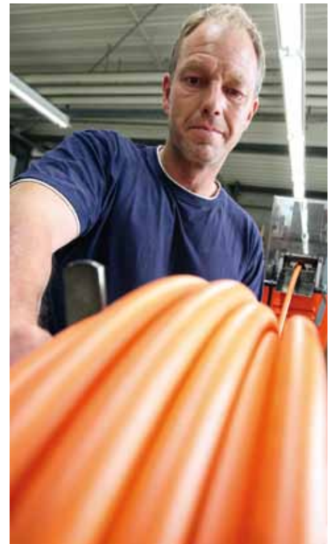
Lange Leitung – rund gewickelt: Ein Mitarbeiter sorgt für transportfähige Waren. Die Farbe Orange zeigt an, dass das Kabel besonders flexibel ist.
